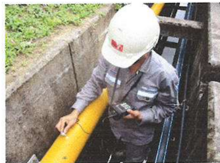
รูปการทดสอบวัดความหนา
